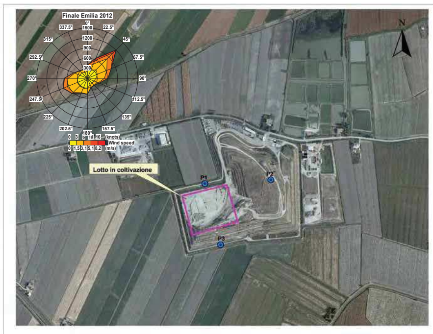
Figura 1 - Planimetria Discarica Mirandola : punti di monitoraggio delle emissioni diffuse e qualità dell'aria
