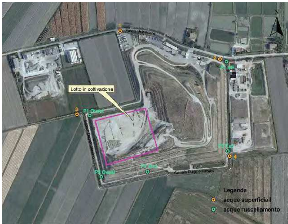
Figura 3 - Planimetria Discarica di Aimag di Mirandola con rete di monitoraggio delle acque superficiali e meteoriche di ruscellamento.
