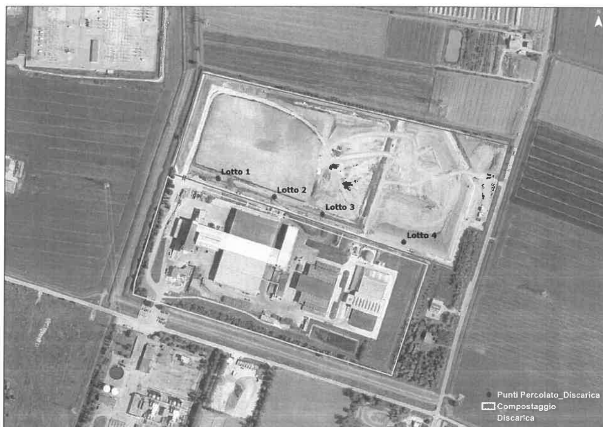
Figura 4 - Planimetria Discarica di Aimag di Fossoli di Carpi con rete di monitoraggio delle acque di percolazione.
