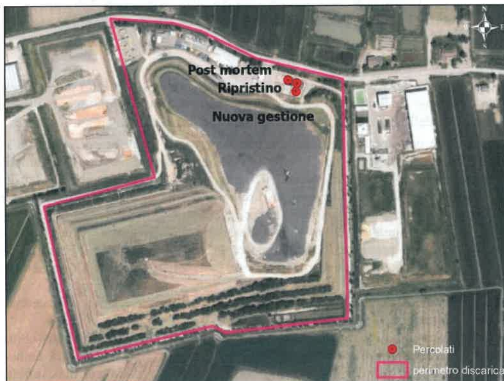
Figura 4 - Planimetria Discarica di Aimag di Mirandola con rete di monitoraggio delle acque di percolazione.
