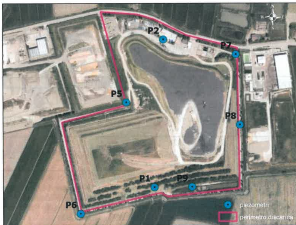
Figura 2 - Planimetria Discarica di Aimag di Mirandola con rete di monitoraggio delle acque sotterranee.
